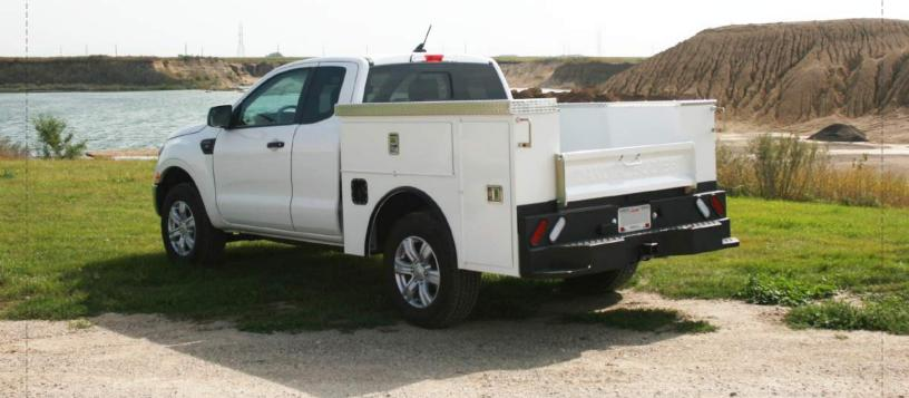
// Aluminum Body // Steel Bumper & Tailgate // Width: 74" // Length: 69" // Height: 38" // Weight: 575lbs //
